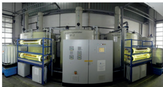
Système AOP complet pour le traitement en continu des bains de ZN-Ni chez KMV pour un volume de 10m 3 /jour
